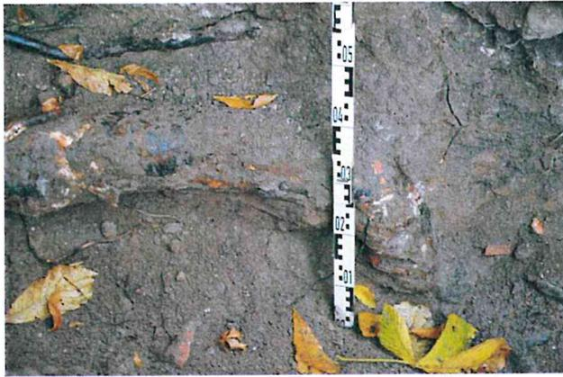
*Bild 9: Bei einer Abgrabung in der Mitte des Suchgrabens müsste auch diese Starkwurzel mit etwa 16 cm Dicke abgetrennt werden*
