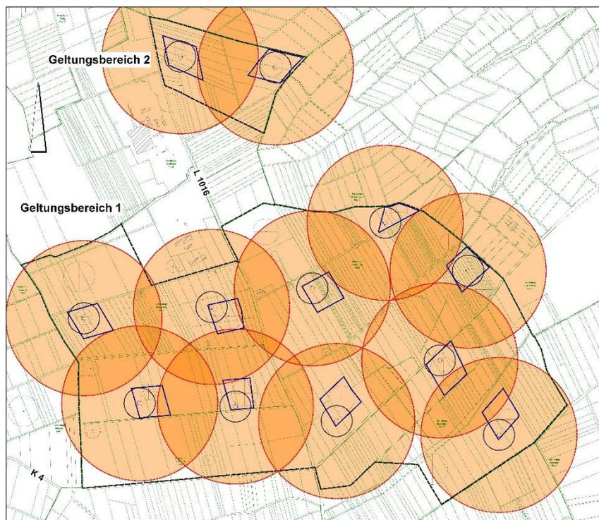
Abb. 10: Beispielanordnung innerhalb der Baufelder, Darstellung der Abstandsflächen
