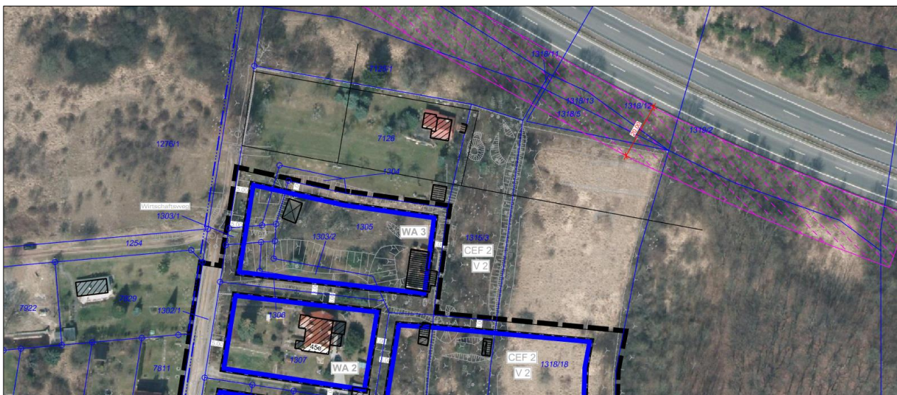
Abbildung 5: Bauverbotzone zur B19 [Quelle: TLBG ©]
