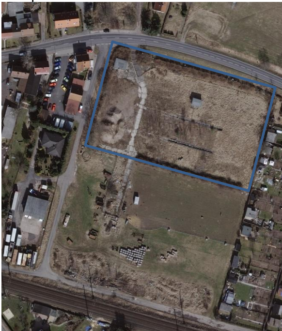
Abb. 8: 2012-03-17_0149* Umspannstation bereits rückgebaut, aber Fundamente noch vorhanden, südl. ans FSt. angrenzender Teil ist Brache
